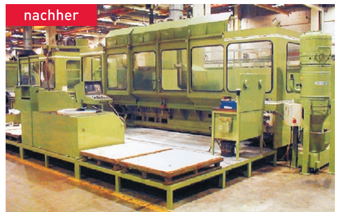
Reinigungsarbeiten während der Grundinstandsetzung des Bearbeitungszentrums Norte VS 2. 1m 3 ölhaltiger Späne und Schmutz mussten entsorgt werden.
