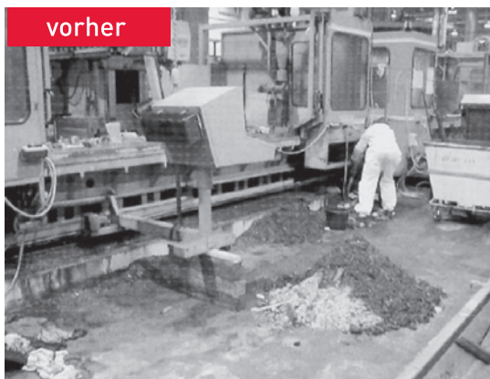
Reinigungsarbeiten während der Grundinstandsetzung des Bearbeitungszentrums Norte VS 2. 1m 3 ölhaltiger Späne und Schmutz mussten entsorgt werden.
